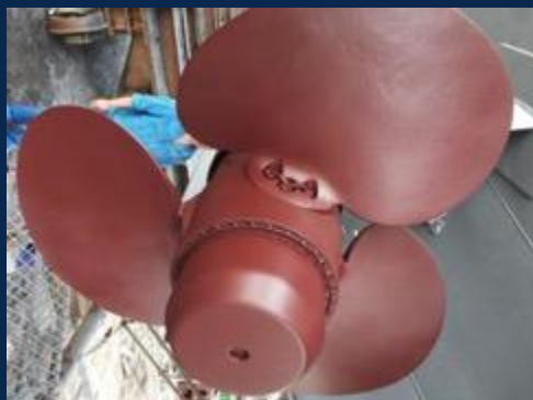
海军榆林基地舰船尾舵 螺旋桨防腐
