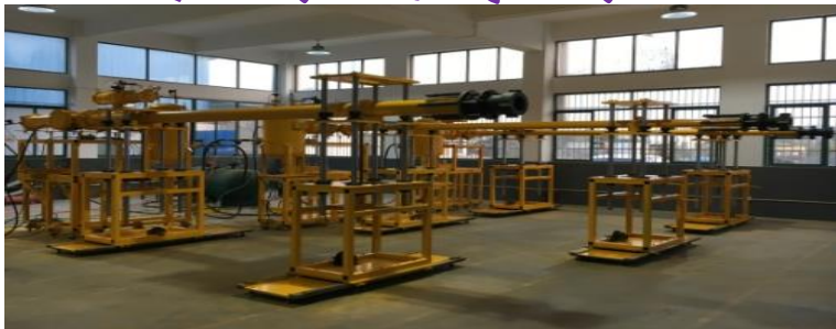
中高速冲击测试系统 (50~300m/s) 外物损伤、机匣包容、吞冰吞鸟等试验
