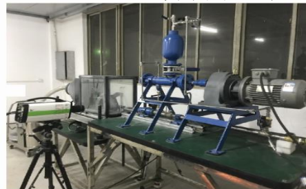
冲蚀试验系统 材料、结构和转子冲蚀测试
