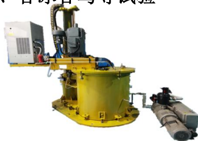
旋转疲劳测试系统 整体叶盘疲劳、破裂测试
