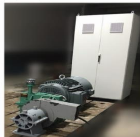
冲蚀试验系统 材料、结构和转子冲蚀测试
