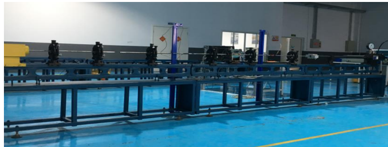
霍普金森杆测试系统 材料动态力学性能测试
