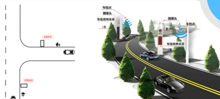
图 3 弯道会车监测及预警示意图
