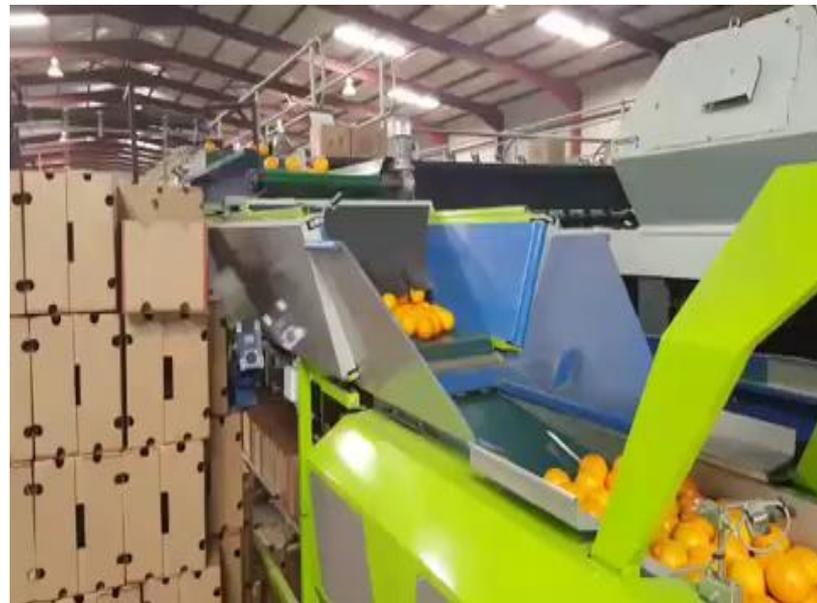
通过自动化技术实现**自动套袋、包膜及装箱**等后续包装工作。
