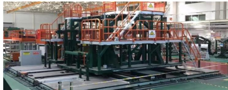
高超音速无人飞机前中机身装配铆接线
