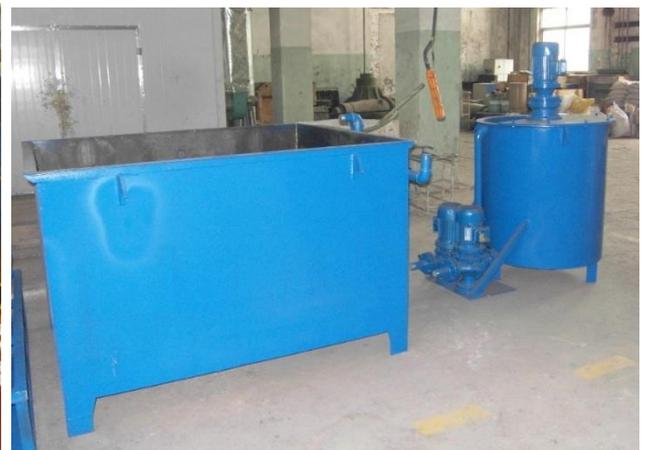
一种大型复杂薄壁壳体件消失模模样的施涂装置
