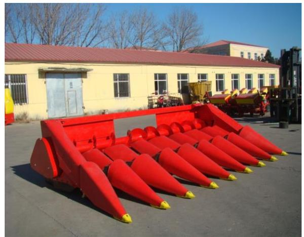
4YTS-4 型大垄双行秸秆同步切碎玉米收割台
