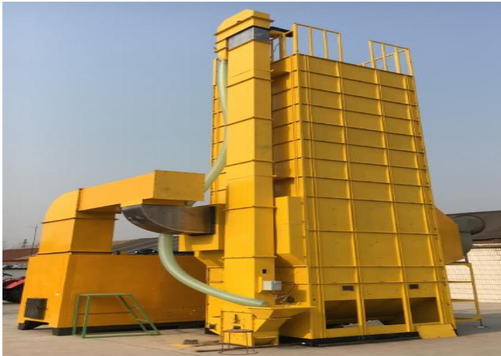
5HXSJ-15 低温循环谷物干燥机样机
