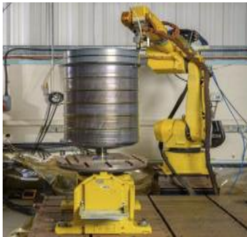
电弧送丝堆焊工艺 适合大尺度内外轮廓复杂构件
