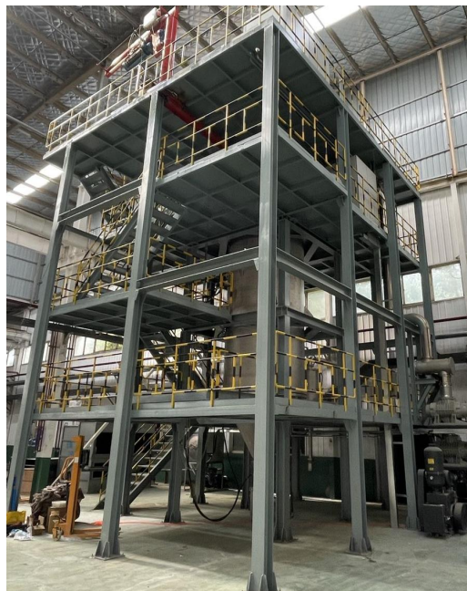
250kg级VIGA型 真空气雾化制粉设备
