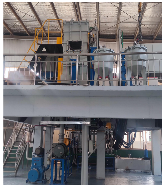
PREP-30000型 等离子旋转电极雾化制粉设备
