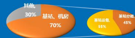
通信设备用电构成图
