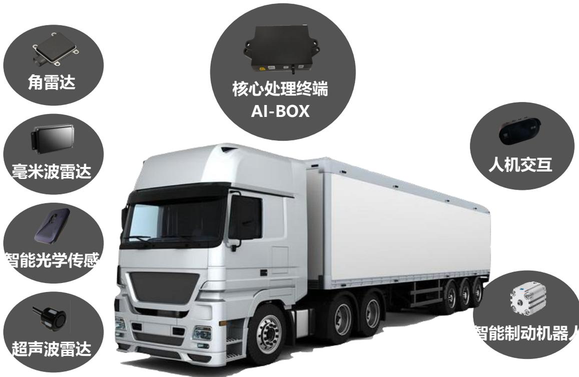
基于**核心处理终端AI-BOX**，配合雷达、摄像头、刹车执行器等，为商用车提供**AEB, FCW, BSD**系统等多种功能
