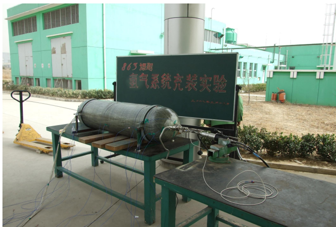
35MPa气瓶充装实验
