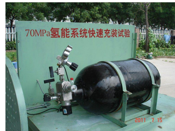
70MPa气瓶充装实验
