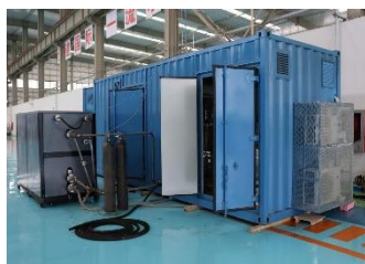
碱性水电解 制氢加氢设备
