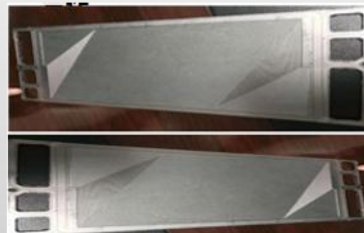
模压加工快速成型，技术成熟，适合批量化生产
