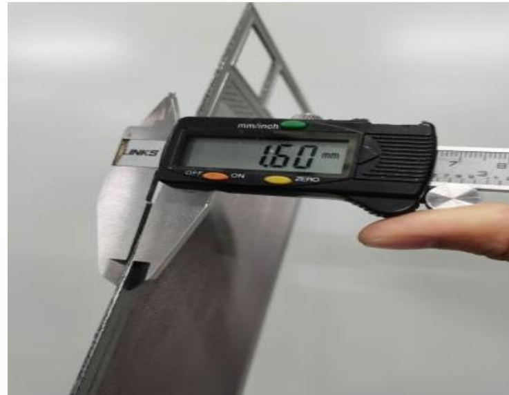
独特设计，已量产全世界最薄的石墨双极板
