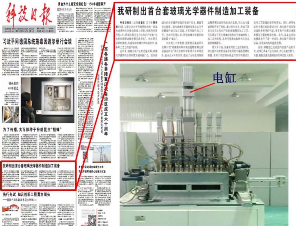
图 8 伺服电机驱动玻璃模压成形机
